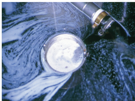
Die Ölfilme folgen dem hydraulischen Gradienten und können separiert werden.
